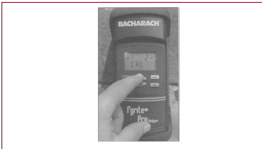
شکل ۸-۱: کالیبراسیون یک دستگاه قرائت مستقیم نوعی
